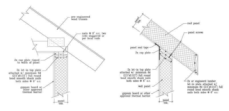
FIGURE 4—TYPICAL ROOF TRUSS TO WALL PANEL
