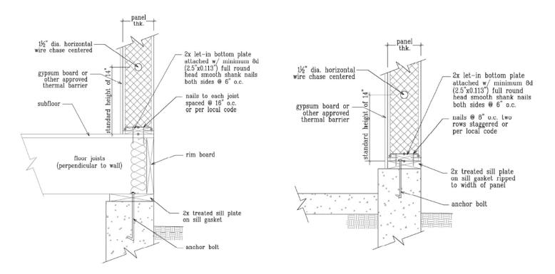
FIGURE 2—TYPICAL WALL PANEL ON FLOOR
